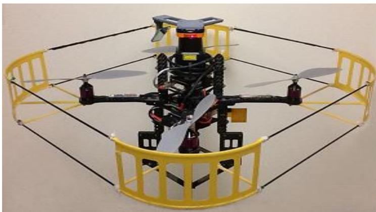
图 4: CityFlyer 四旋翼飞行机器人试验平台，配置有 Hokuyo 激光测距仪做为主要的外部环境感知器件。
